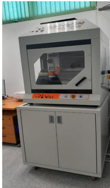
Fresadora SENSOR MÉDICA. Sistema automatizado de confección de soportes plantares bajo digitalización del pie mediante scanner.
